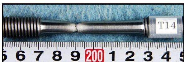
写真2 溶着金属引張試験片破断後
