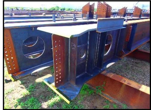
写真1 フランジ端部拡幅梁
