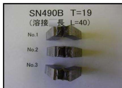
写真2 衝撃試験片破面
