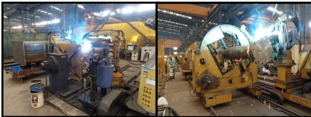
写真1 溶接ロボットによる自動溶接
